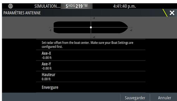
La position approximative de l'antenne sur le bateau doit être définie afin de positionner correctement le profil du bateau lors de l'affichage des paramètres de courte distance. Le PPI sera centré sur l'icône représentant la position de l'antenne.
