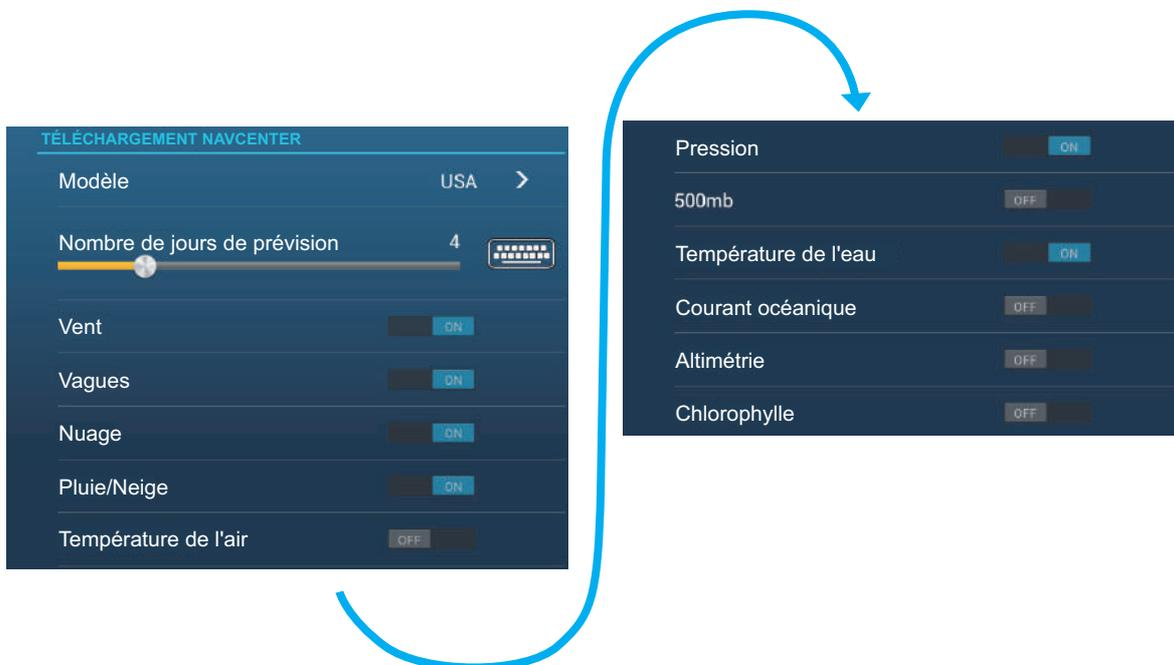
6. Appuyez sur le modèle de données dans [Modèle] dans la section [Téléchargement NavCenter]. (Les options sont [USA] et [Monde entier].)
