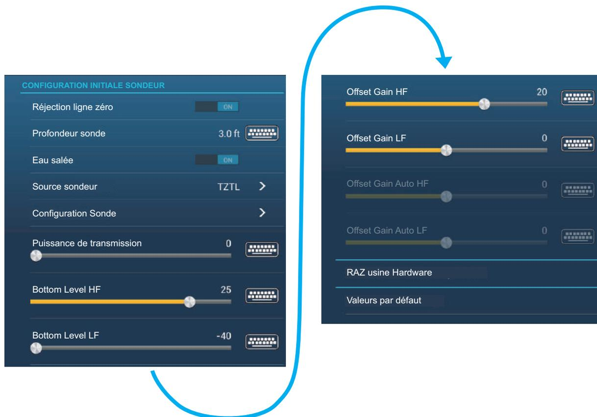
**[Réjection ligne Zéro]:** Activer ou désactiver la ligne zéro (ligne de transmission). Si cette option est activée, la ligne de transmission disparaît, ce qui donne un meilleur visuel des échos de poisson à proximité de la surface. La longueur de la ligne de transmission dépend de la sonde utilisée et des caractéristiques de l'installation.
