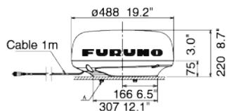
Capteur radar radôme 24" DRS4D-NXT 7.3kg 16.1 lb
