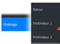
Dans l'exemple suivant, une profondeur d'eau de 5 à 10 mètres est représentée par une nuance de jaune sur la carte lorsque Depth 1 est la nuance sélectionnée dans le menu.
