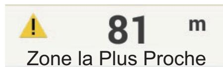
Dans le cas des zones et des cercles, lorsque le bateau entre dans la zone, la zone devient rouge et clignote. Aussi, dans la barre d'état, le message « Dans la zone d'alarme : Zone » (ou Cercle) apparaît et l'alarme sonore retentit.
