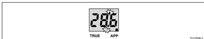
L'**alarme Angle du vent apparent bas** retentit quand l'angle du vent apparent est égal ou inférieur au **seuil d'angle de vent apparent bas**. L'alarme continue à sonner jusqu'à ce qu'elle soit manuellement arrêtée.
