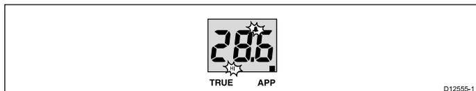
L'**alarme Angle du vent apparent élevé** retentit quand l'angle du vent apparent est égal ou supérieur au **seuil d'angle de vent apparent élevé**. L'alarme continue à sonner jusqu'à ce qu'elle soit manuellement arrêtée.
