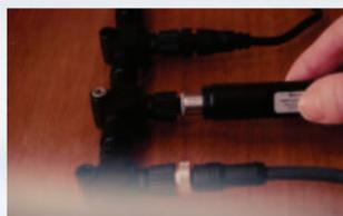
BaroPlug est un capteur de pression atmosphérique et de température ambiante pour les instrumentations NMEA2000. Il comporte un connecteur MICRO C mâle pour se connecter directement sur un bus NMEA2000. Il s'agit un appareil "Plug and Play" : il suffit de le brancher sur la "backbone" de l'installation NMEA2000
