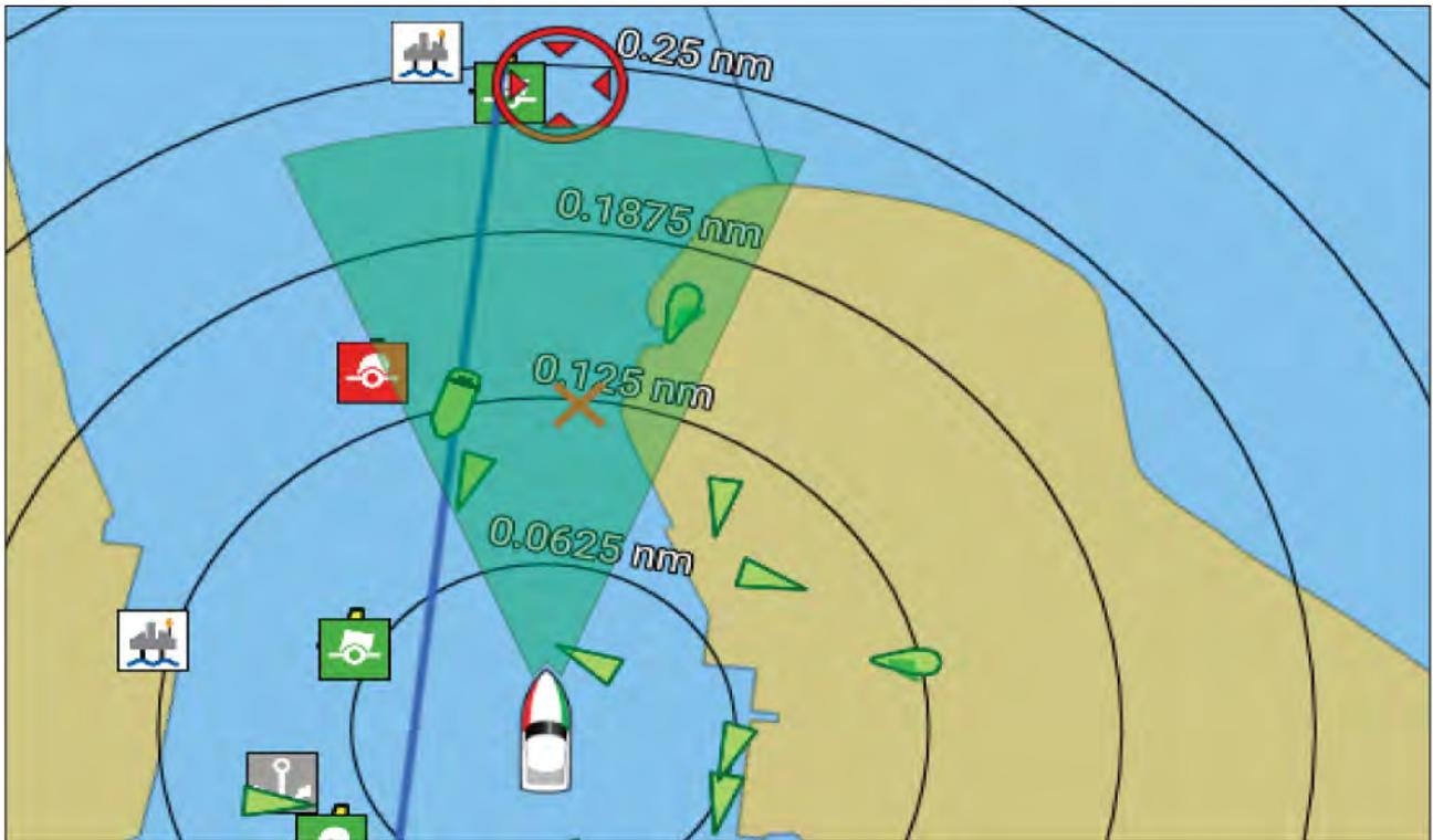
Le cône FOV peut être activé/désactivé dans les paramètres de l'application Carte : **Menu > Paramètres > Couches.**
