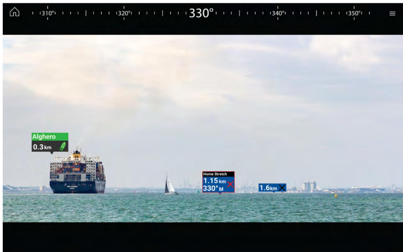
La fonctionnalité de **réalité augmentée** superpose des couches d'informations numériques directement sur le flux vidéo de l'application Vidéo. Les objets provenant de la cartographie sont utilisés pour générer des images (indicateurs) et du texte informatif sur l'application Réalité Augmentée. Quand elle est correctement étalonnée, la fonction ClearCruise™ superpose des indicateurs précis et automatiquement actualisés sur la vidéo de la caméra.
