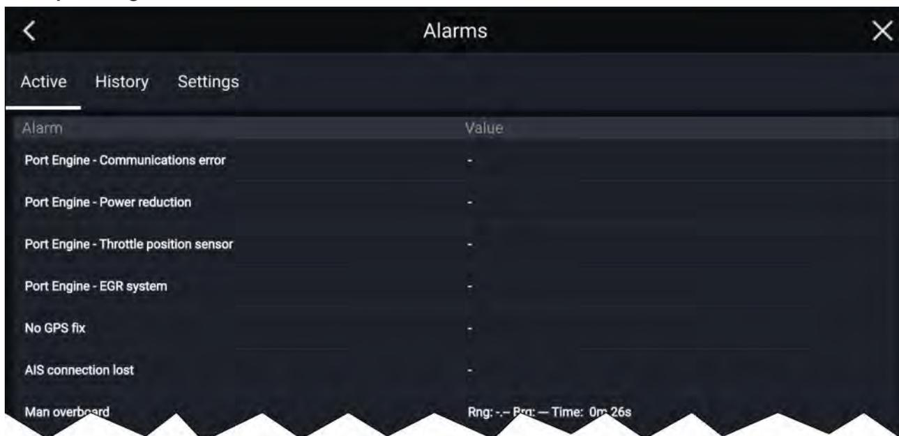
L'onglet Alarmes actives liste toutes les alarmes actives. Les alarmes restent actives jusqu'à ce que les conditions qui ont déclenché l'alarme ne soient plus présentes, p. ex. une alarme de hauts-fonds est automatiquement supprimée quand la profondeur augmente.
