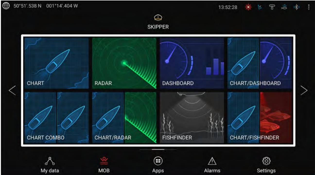
Les applications MFD s'ouvrent en sélectionnant des icônes de la page des applications, disponible sur l'écran d'accueil. Ces applications comprennent Carte, Radar, Fishfinder etc. Les applications MFD sont disponibles sur tous les MFD exécutant le système d'exploitation LightHouse™ 3. Il est possible d'afficher plusieurs applications en même temps en créant des pages d'application.
