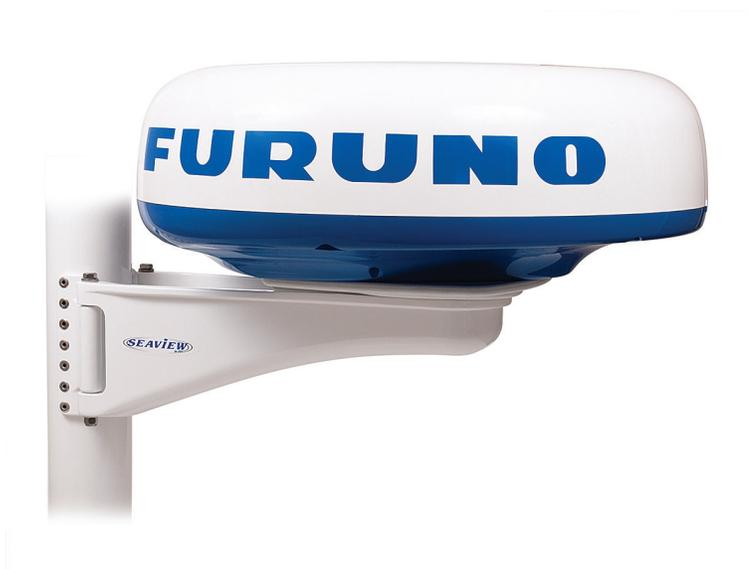
Chaise de mât Seaview pour radome Furuno. Fabriqué en acier de qualité marine avec un traitement chimique pour plus de longévité. Puis peint avec une peinture époxy brillante en poudre cuite au four. Le support est prévu pour recevoir une corne de brume ou un feu de pont. Différents accessoires sont disponibles comme le guard en inox ou l'adaptateur de flybridge.
